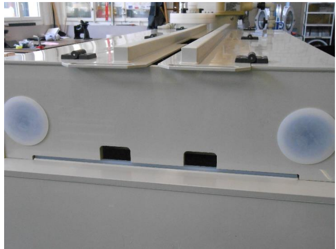
Aufsatz mit Deckel aus PP, zu isolierter Galvanikwanne
