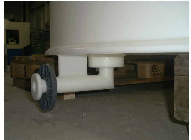
Entleerung mit Vorschweissbund und Losflansch in flachem Tankboden
