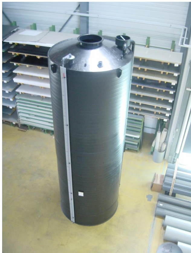
Zylindrischer Lagertank, gefertigt aus PE – Wickelrohr.
