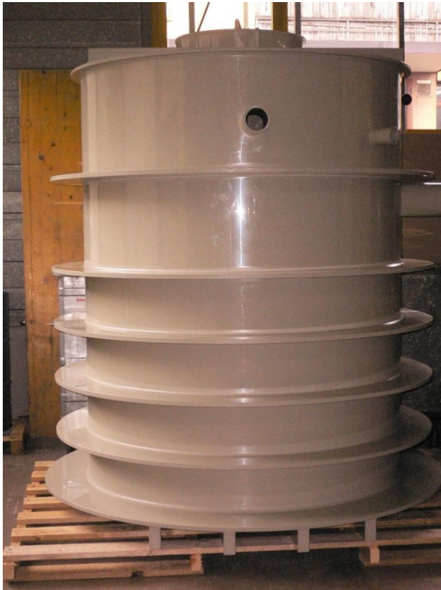
Zylindrischer Behälter aus PP mit rundum verschweissten Rippen
