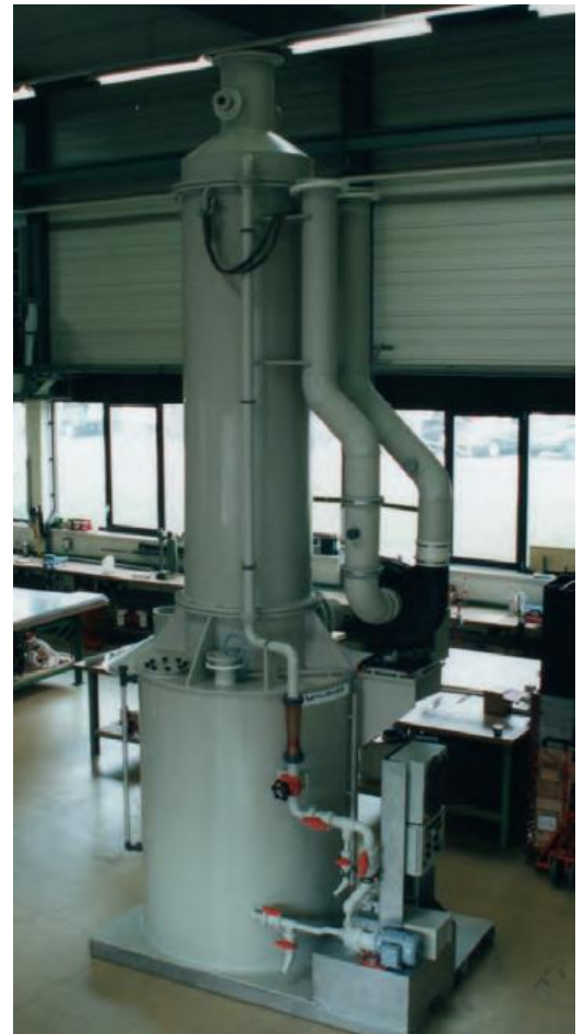
Chemieabluftwäscher aus PP mit Washwasservorlage und integriertem Tropfenabscheider
