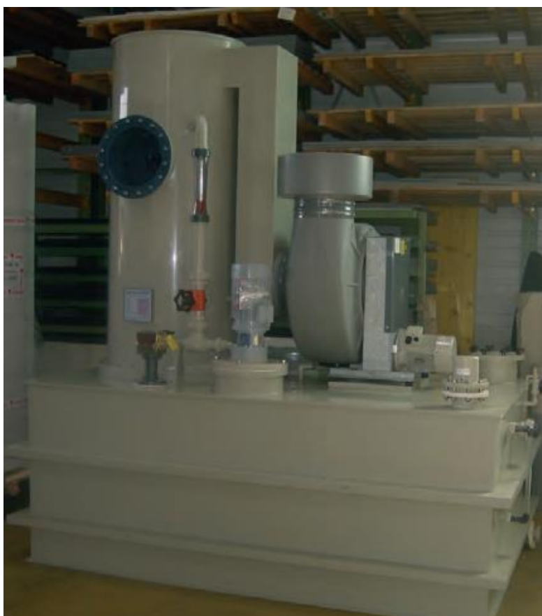
Ammoniakwäscher aus PP mit PP-Ventilator und Überwachung der Sättigung in der Waschwasservorlage
