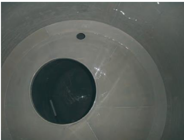
Mit ECTFE verkleidete Schwallwand eines Chromstahltankwagens
