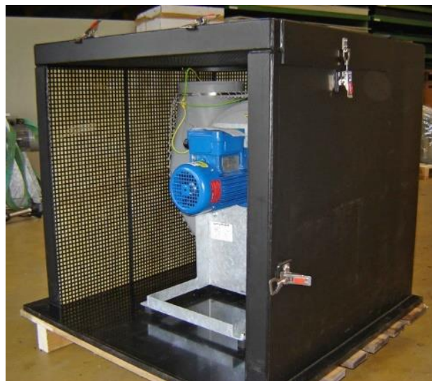
Ventilator - Abdeckung als Schalldämpfer ausgebildet aus UV - beständigem PE
